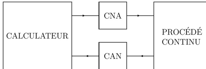
FIG. 4 – Commande numérique d'un processus continu
