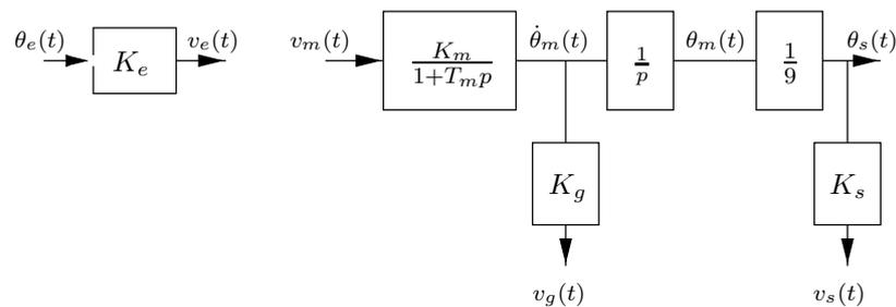
Il est constitué d'un ensemble {moteur à courant continu, réducteur, génératrice tachymétrique} et de deux potentiomètres.  $K_m$  désigne le gain en vitesse du moteur et  $T_m$  sa constante de temps mécanique.  $K_g$  est le gain de la génératrice tachymétrique.  $K_e$  et  $K_s$  sont les gains respectifs des potentiomètres de consigne et de sortie.
