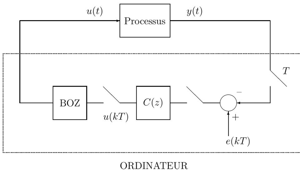
FIG. 1 – Processus continu dans une boucle numérique d'asservissement
