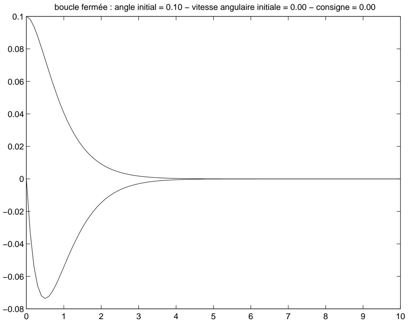
FIG. 2 – Comportement du système en boucle fermée pour une consigne nulle et un angle initial non nul (les 2 courbes représentent l'évolution de  $\theta$  et  $\dot{\theta}$ )
