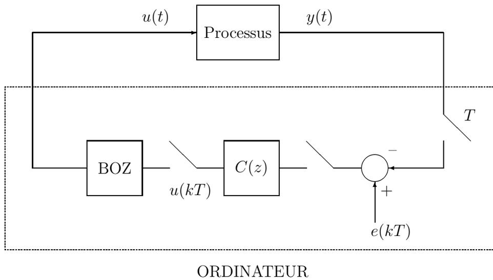
FIG. 2 – *Processus continu dans une boucle numérique d'asservissement*
