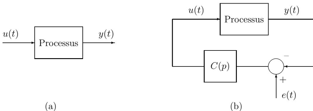
FIG. 1 – (a) *Processus continu en boucle ouverte* - (b) *Processus continu dans une boucle analogique d'asservissement*
