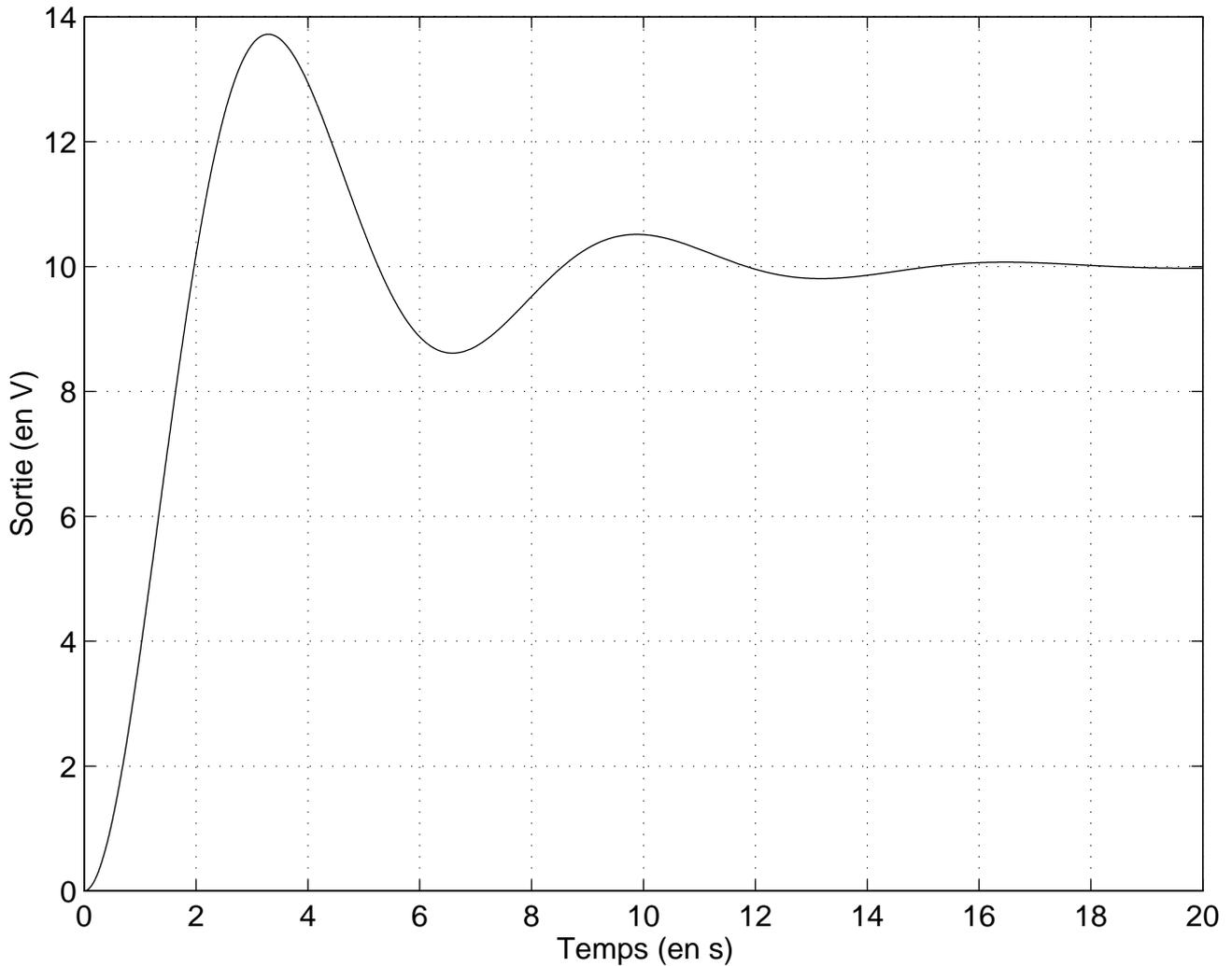
FIG. 4 – Réponse du système à un échelon unitaire
