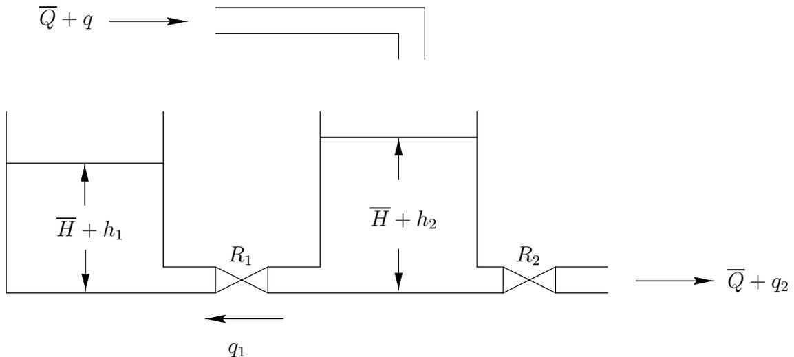
FIG. 2 – Deux réservoirs en série
