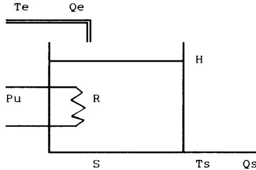
FIG. 3 – Régulation de niveau et de température d'un bac
