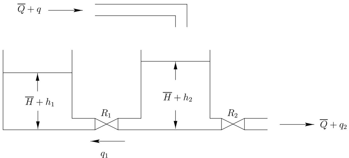
FIG. 2 – Deux réservoirs en série
