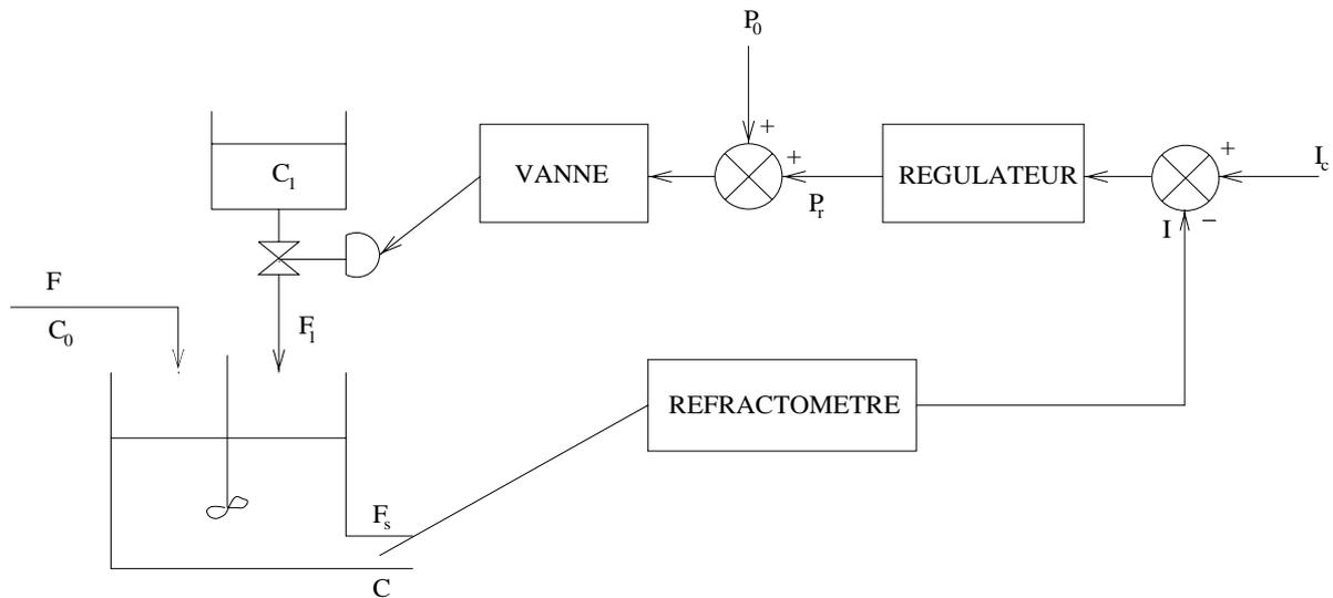
Un bac parfaitement agité, de volume constant  $V$  est alimenté avec une solution très diluée de concentration  $C_0$  en produit A.
