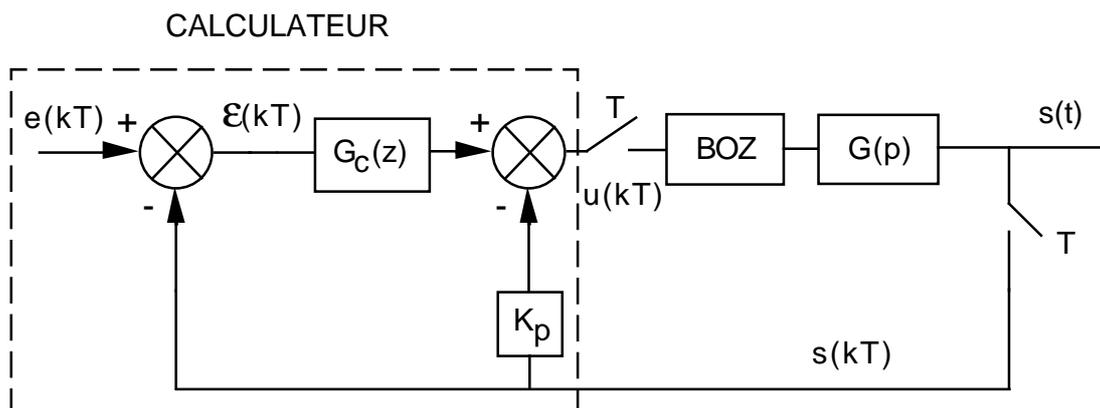
FIG. 3 – Asservissement échantillonné avec correction
