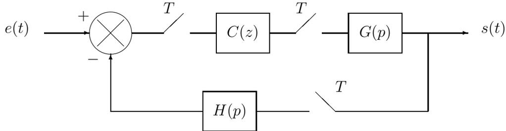
FIG. 3 – Un système bouclé échantillonné
